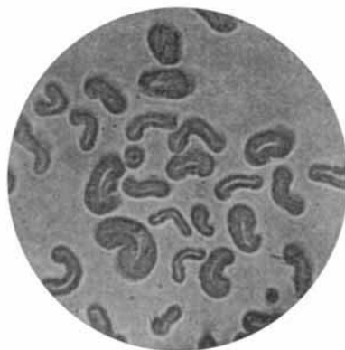
Abb. 1 b. Fasercellulosemonoacetat, aus nicht mercerisierter Baumwolle, vollständig durchgefärbt, mit 1,4-Diaminoanthrachinon.
